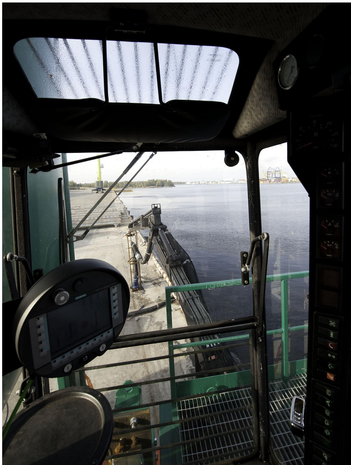
Figur 29. Foto visande ProSol maskinens förarhytt och kranarm med pump för uppfodring av muddermassor. Foto Per Lindh.
