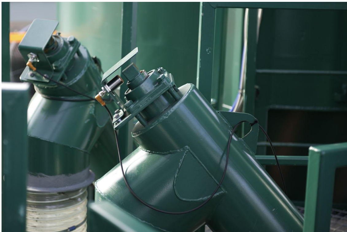
Figur 30. Givare för att kontrolleras matarskruvarnas rotation. Foto Per Lindh.
